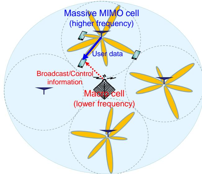
図 12 – Massive MIMO とファンタムセルの組み合わせ
