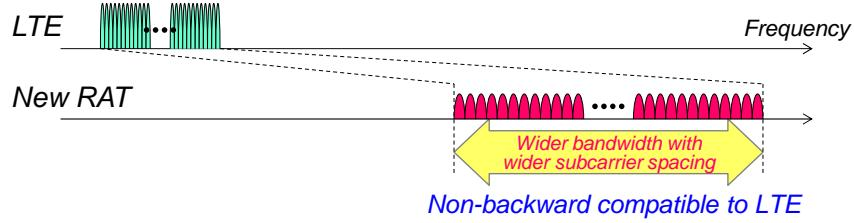
図 9 – New RAT を実現するスケーラブルLTE無線パラメータ
