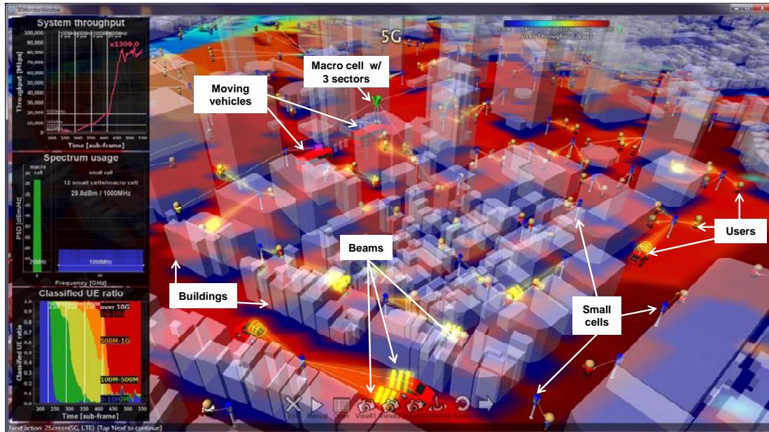
新宿エリアの伝搬環境をレイトライシング法より模擬した。マクロセルの送信アンテナ数は 2 とした。スマートセルにおける Massive MIMO(64 アンテナ素子)のプリコーダとしてエルミートプリコーディングを用いており、チャネル情報は既知とした。なお、Massive MIMO 送信時はシングルユーザ MIMO とマルチユーザ MIMO の動的な切り替えやランクアダプテーションを行い、周波数利用効率を向上させている。2 GHz 及び 20 GHz の端末側の受信アンテナ数は 4 とした。
