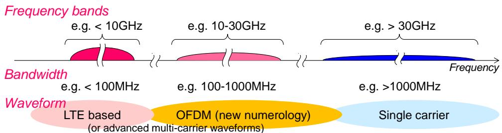
図 10 – New RAT における周波数帯に応じた信号波形の適用例
