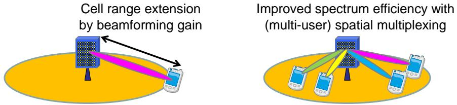
図 11 – Massive MIMO 技術の適用効果
